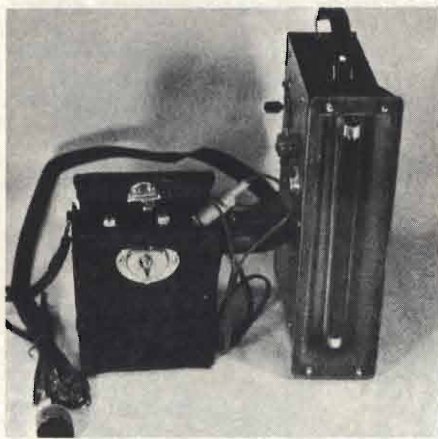
Fig. 12 - Il generatore di luce ultravioletta interamente montata, ed il relativo contenitore per le batterie. Sulla parte frontale del generatore si osserva il tubo cilindrico che produce i raggi che rendono visibili diversi dettagli non apprezzabili con la luce normale.
