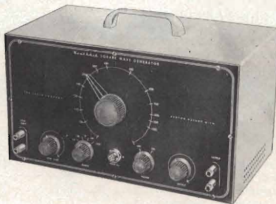
Fig. 9 - Generatore di onde quadre Heathkit "SQ1"; circuito elettrico ed aspetto.
